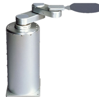
半導体ウエハー搬送用ロボット (株)ダイヘン様提供
